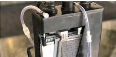
Doppelrohrdurchführung bei Elektrolytumwälzung (EUW)
