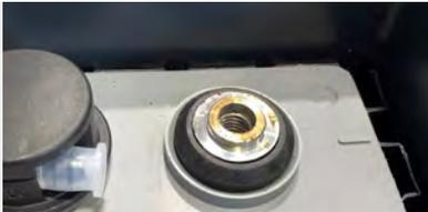
Batteriepol in Gleitpolausführung
